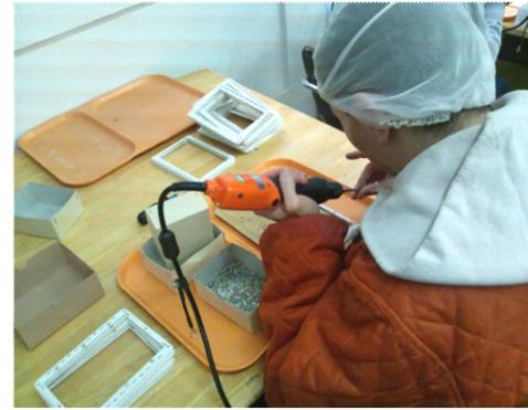
●電動ドライバーを使ってネジ締め
