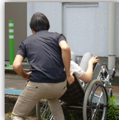
大車輪を段差に接触させて
