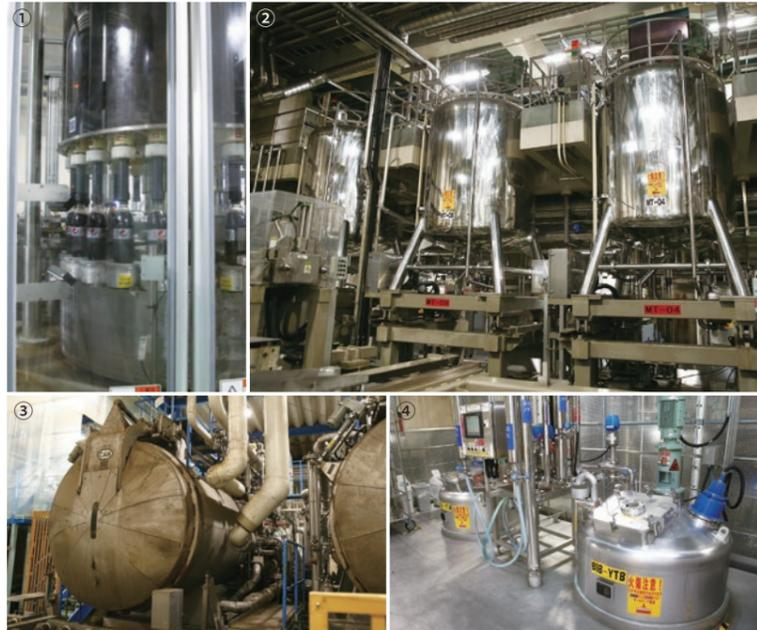
①500mlペットボトルの充填装置 ②移動式タンクで多品種の製造が可能 ③かごに入れた缶コーヒーを高温高圧殺菌するレトルト釜 ④原材料の投入口は安全に配慮され、清潔に保たれている
