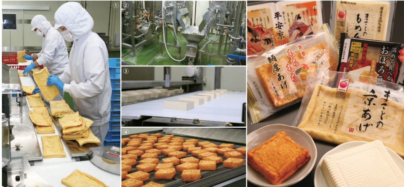
①破れやこげがないか、人の目で確認する ②③④大豆をすり潰し、搾った豆乳から豆腐を作り、整形加工し、油で揚げなどの工程を機械化・自動化。厳しい衛生管理の下で、美味しい豆腐や加工品が製造されている
