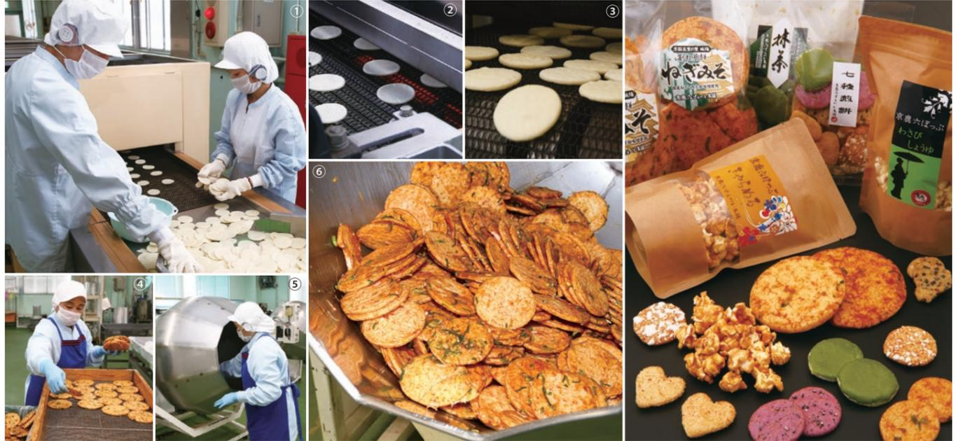
①②③炉で生地を飛ばした後、焼成機に入れる。遠赤外線三段階の焼きで、サクサクの食感に ④⑤⑥せんべいと共に特製のみそだれ、刻んだ生ネギをドラムに入れて味をつける
