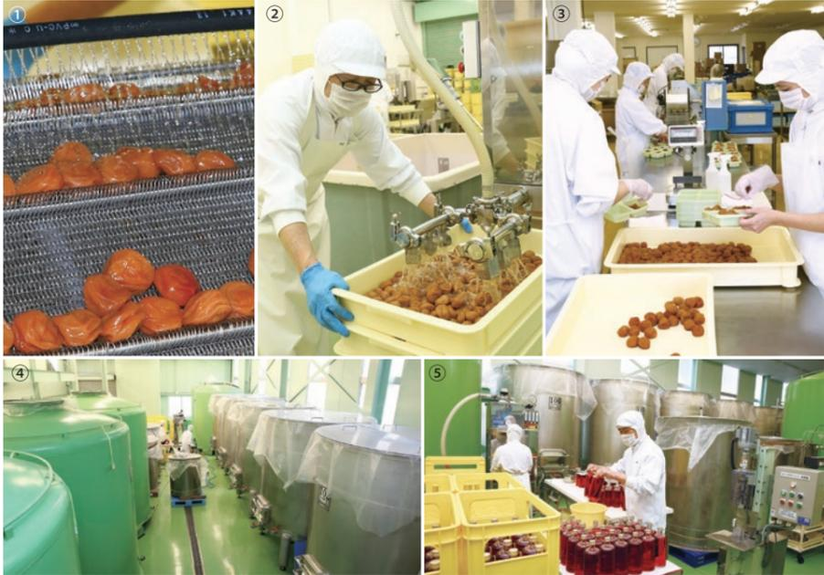
①入荷した梅干しを洗浄する ②負荷を減らすよう改良した装置で漬け液を充填 ③完成した梅干しは丁寧にひとつずつ箱詰 ④⑤6年前に完成した梅酒蔵に巨大タンクが並び、静かにじっくりと熟成されていく
