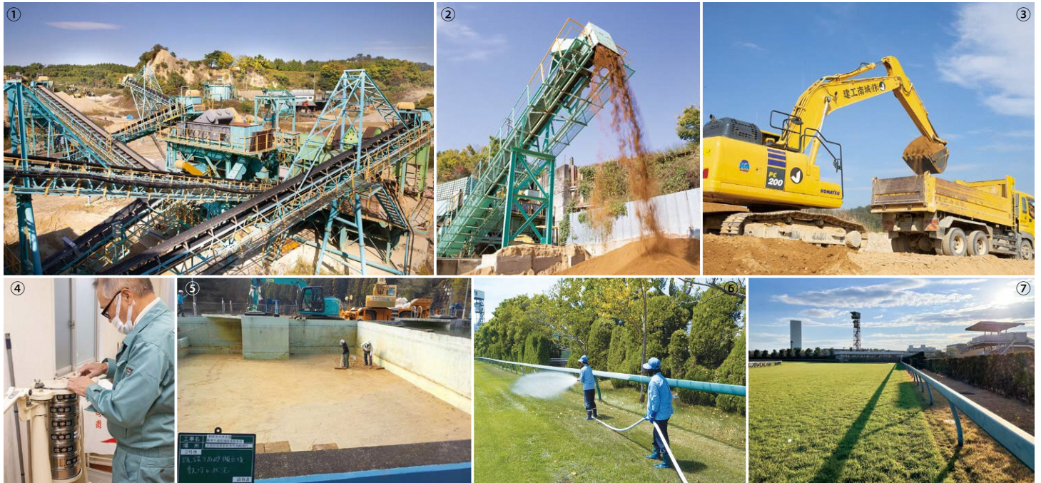
①掘った土を土や砂や石に分別する独自のプラント ②③選別された土は仮置され、洗浄、研磨、ブレンドなどを経て製品化される ④砂の粒子や成分を調べる検査室 ⑤浄水場の施工も手掛けている（和東町） ⑥⑦競馬場に常駐の社員がいて、芝の管理育成やダートコース造りに携わる。移動式プラントで競馬場の砂の再利用も行う
