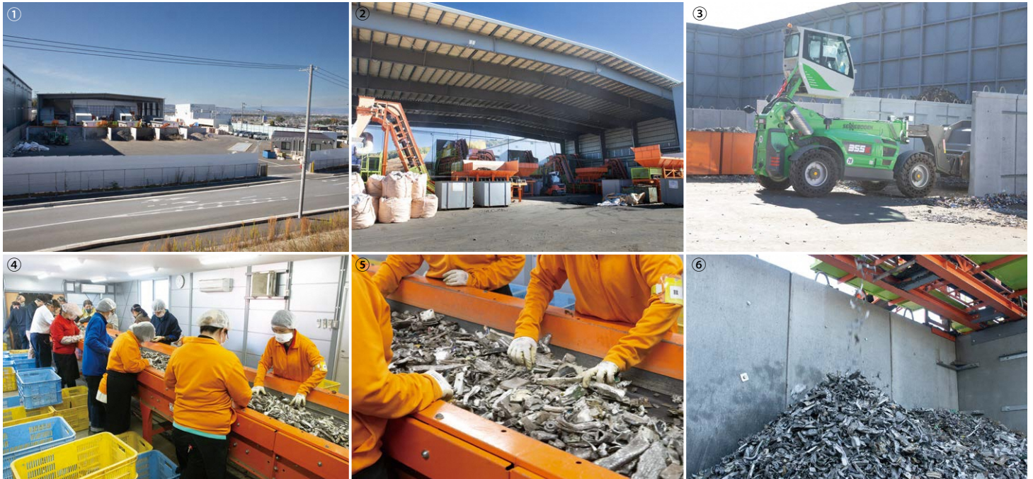
①月に3000t以上の処理能力を誇る第3工場 ②③ブルドーザーで搬入口に投下された資源ごみは、ベルトコンベアで高度選別機、手選別室などへ運ばれて、選別される ④⑤冷暖房・空調の完備した室内で多くのスタッフにより最後の選別とチェックが行われている ⑥非鉄金属ごとに仕分けられ、リサイクル会社へと納品される
