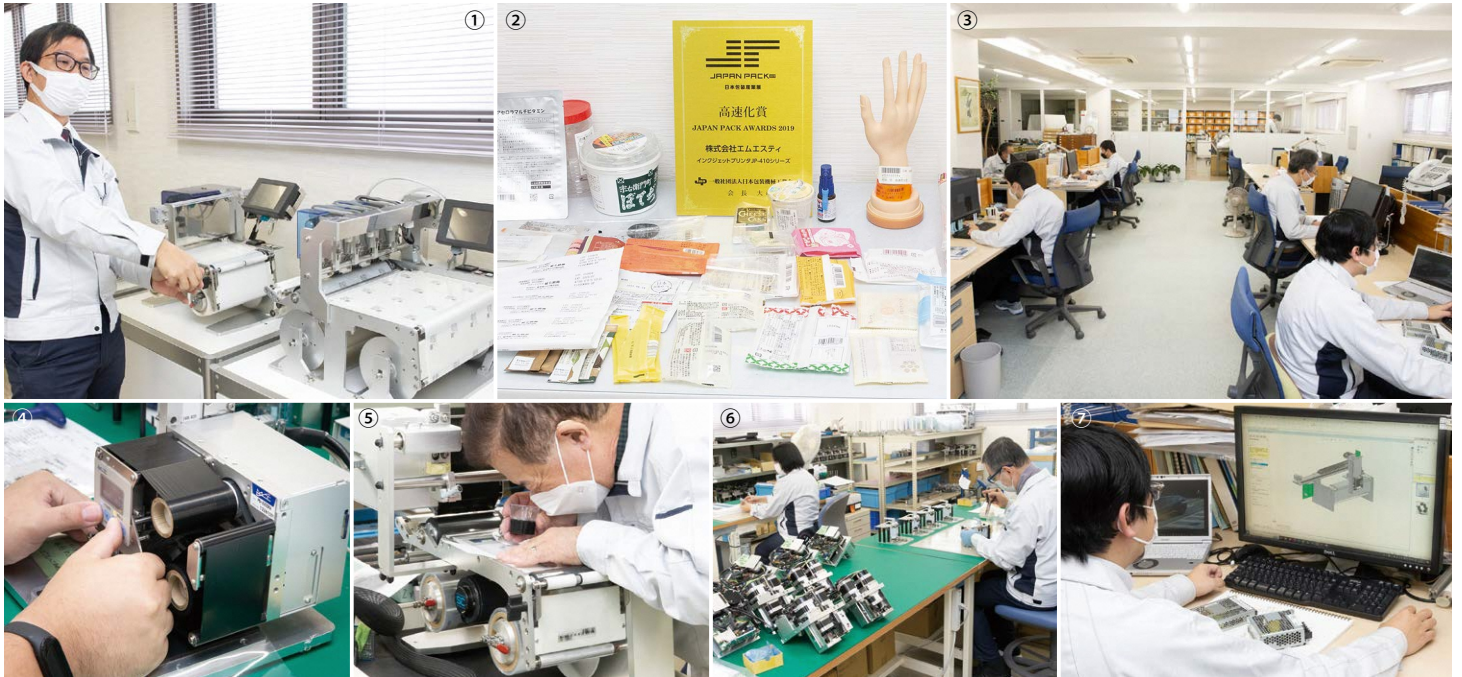
①ショールームのプリンタを説明する坂本代表 ②食品、医薬品などのパッケージの印字に使われる ③⑦機械設計・回路設計・ソフト設計が一貫して行われる技術部門 ④⑤納品前の操作・動作の確認 ⑥社内でパーツごとに製作され、組み立ても自社で行われている
