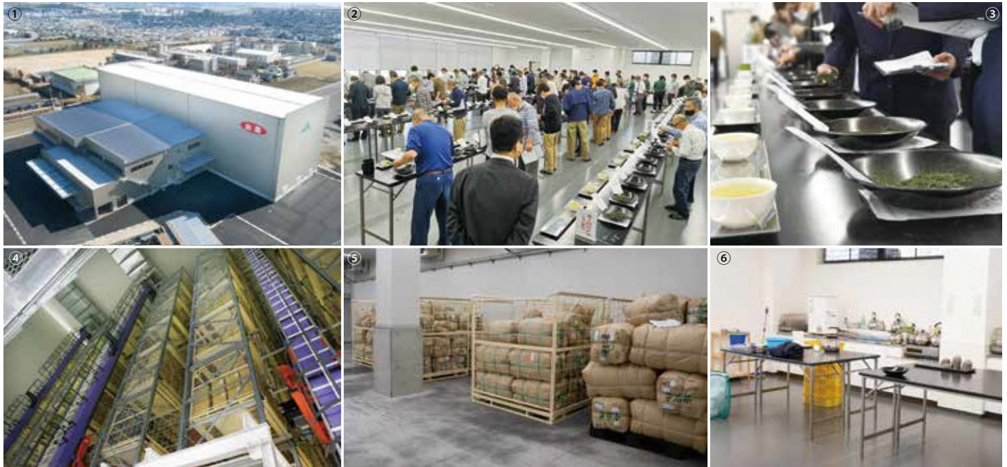
①上空から見た宇治茶流通センター。奥の建物がすべて茶専用冷蔵庫。②③入札会場。茶匠や茶問屋の方が手ざわり、水色、香り、味をチェックして欲しい荒茶を探す ④冷蔵庫内は自動専用コンテナで入出荷が素早く行われる ⑤荒茶を痛めないように予冷库で出荷前に保存される ⑥抽出液を作るためにコンロや流し台が併設
