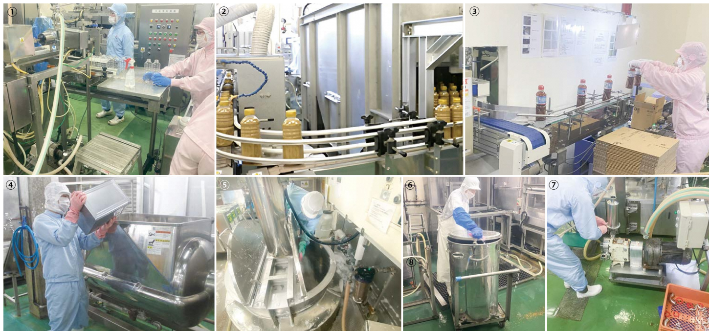
①充填作業前にペットボトルのチェック作業も重要な仕事 ②ドレッシングが自動で充填されてラインで運ばれる ③機械だけでなく目視によるチェックで安全性が高まる ④原料を大きなニーダー（鍋）に投入 ⑤⑥使用が終わると全ての機械は新品同様の美しさまで洗浄して、別の製品の充填にかかる ⑦機械の修理やメンテナンスも社員が行う
