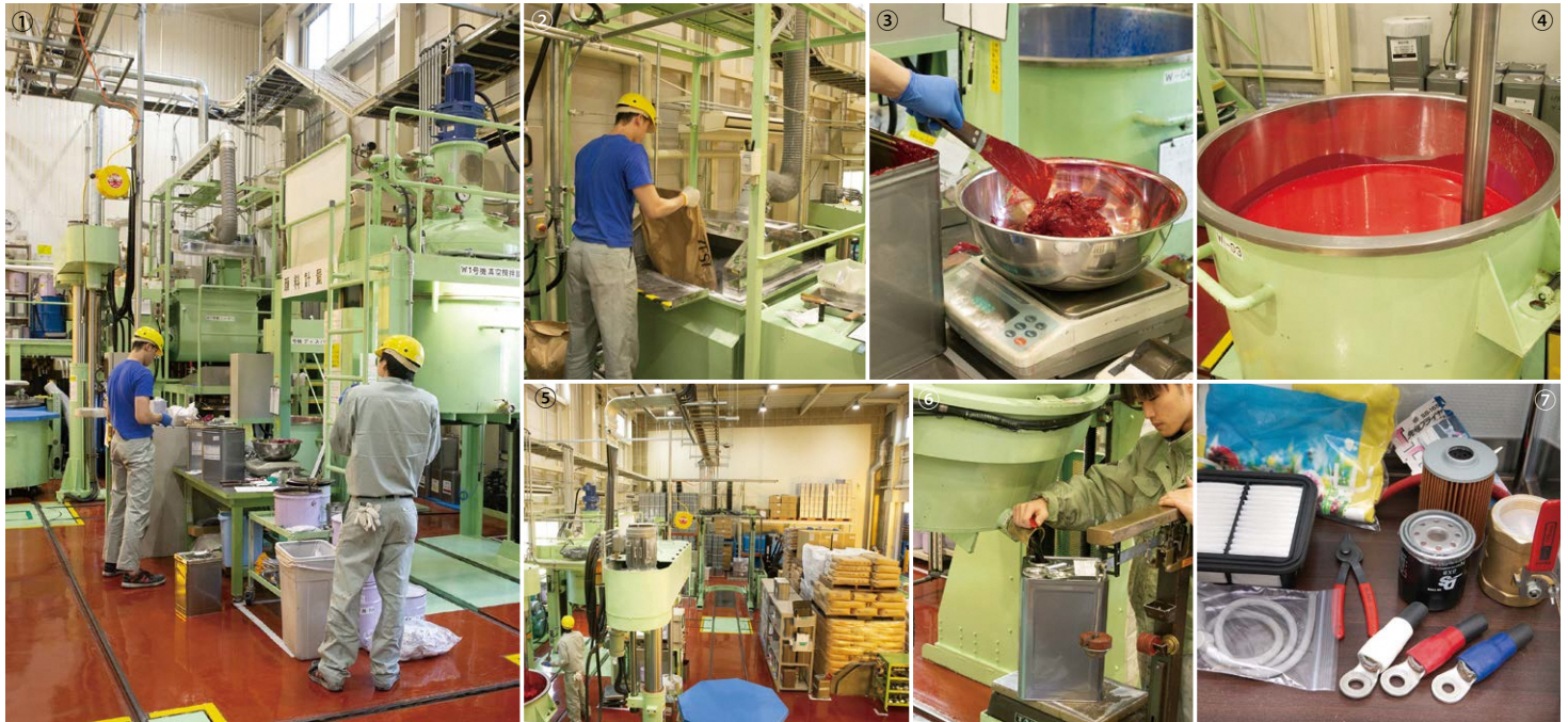
①③工程順ライン化された工場内。整理整頓され、高熱や轟音を発しないので快適に仕事ができる ②攪拌機に原材料を投入する様子 ③④製品ごとに分量が異なるので材料の計量は何度も確認が行われる ⑤製品を一斗缶などの容器に充填して完成 ⑦配線カーバーなどコバゾールが使われている製品
