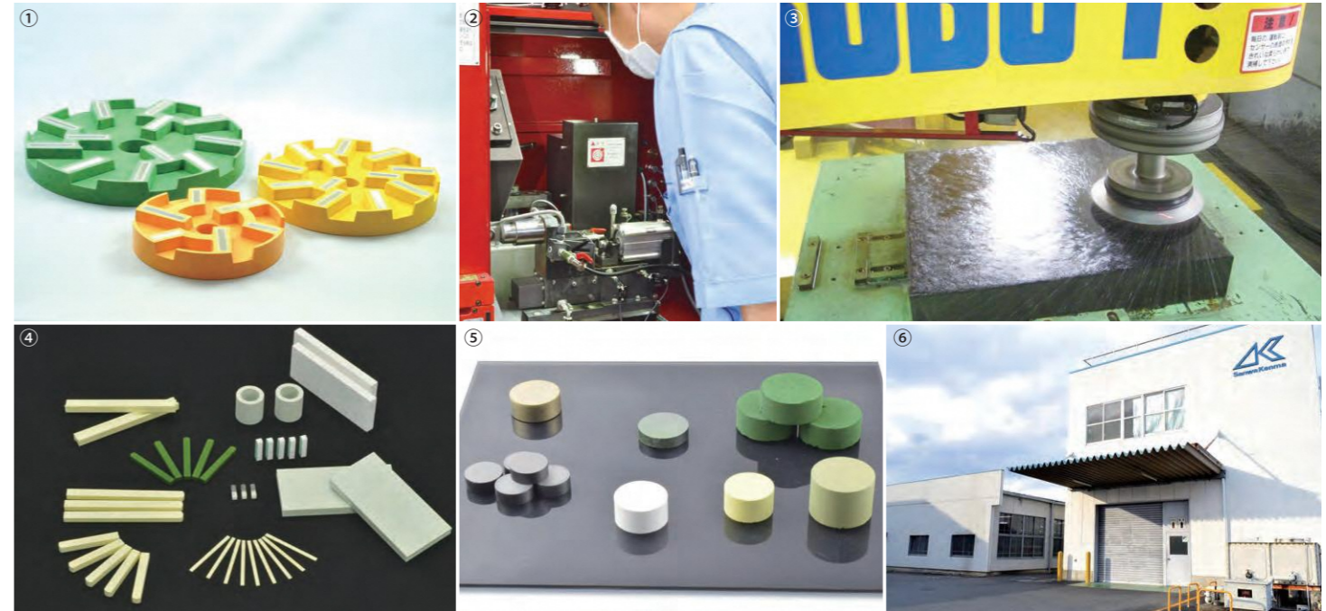
①城陽工場生産品 石材研削ダイヤモンド工具 ②③お客様の使用条件に近い環境での商品開発を進めるため各種加工機械を設備している ④ベアリング軸受軌道研磨用途の超仕上げ砥石 ⑤城陽工場生産品 真空蒸着材料 ⑥城陽工場全景
