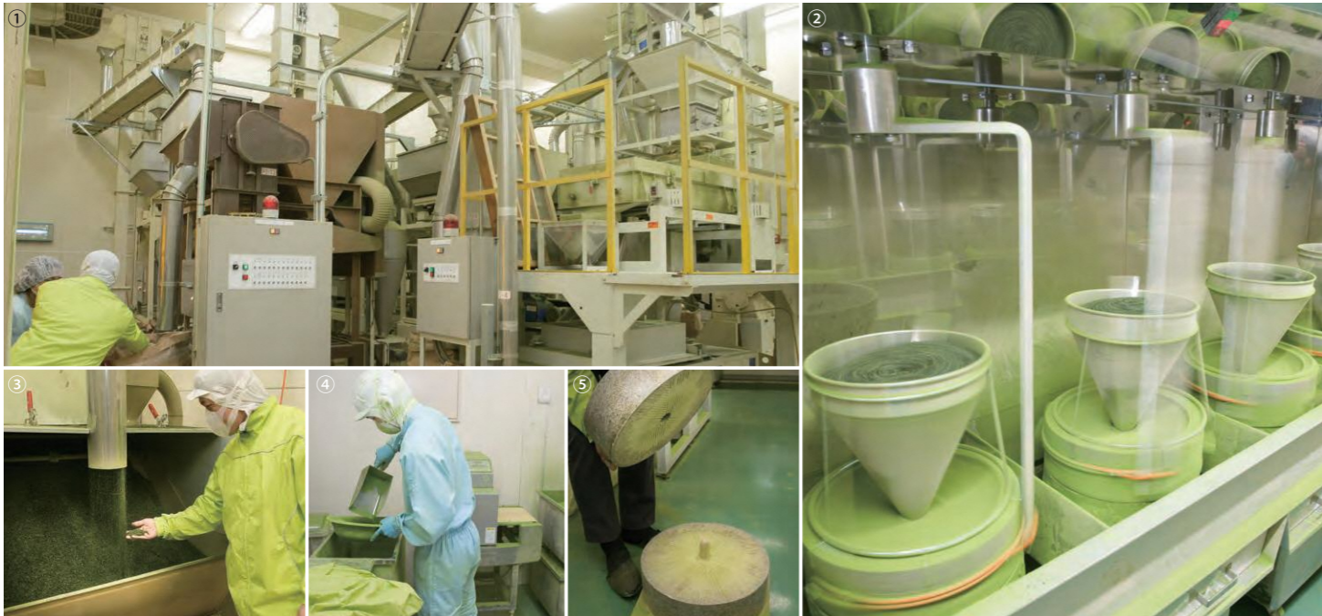
①③荒茶の茎や葉脈を自動で取り除く仕立ての自動化ライン ②石臼で挽いて最高級品質の宇治抹茶ができる ④石臼で挽いた抹茶に異物や金属が混入していないか確かめるために必ず金属探知機を通して ⑤石臼は上下の石で擦りつぶし、細かく彫られた溝を通して出てくる
