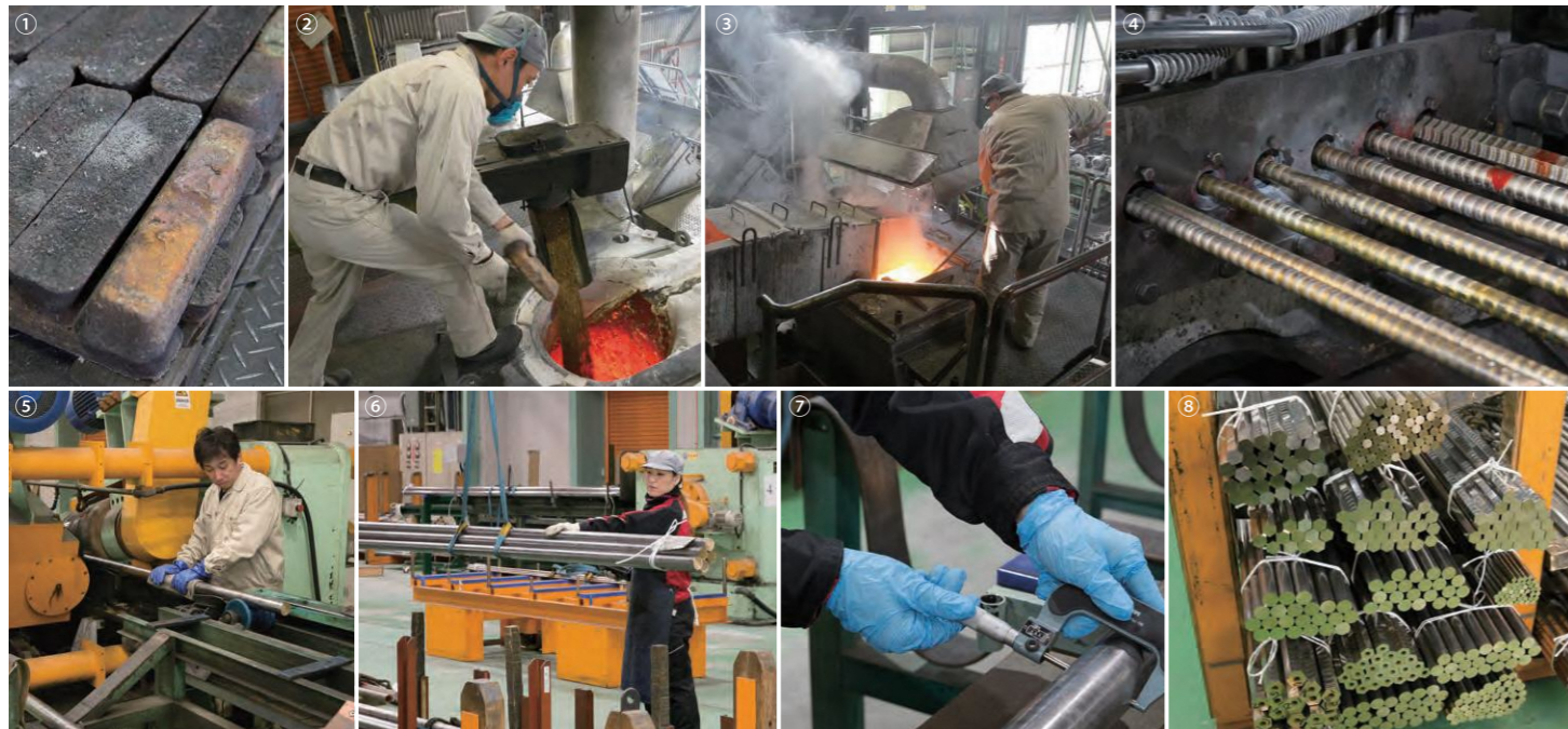
①亜鉛、スズ、インコットの原料にはリサイクルされたものも使う ②炉に原料を入れる作業 ③炉で溶かした原料を鋳造炉に入れる ④連続鋳造で良質な鋳造棒を生産する ⑤鋳造棒を歪みがなくなるように矯正加工を行う ⑥⑦高精度の品質チェックを行い、職人の目でさらに厳しく検査を行う ⑧出荷を待つ、完成した製品
