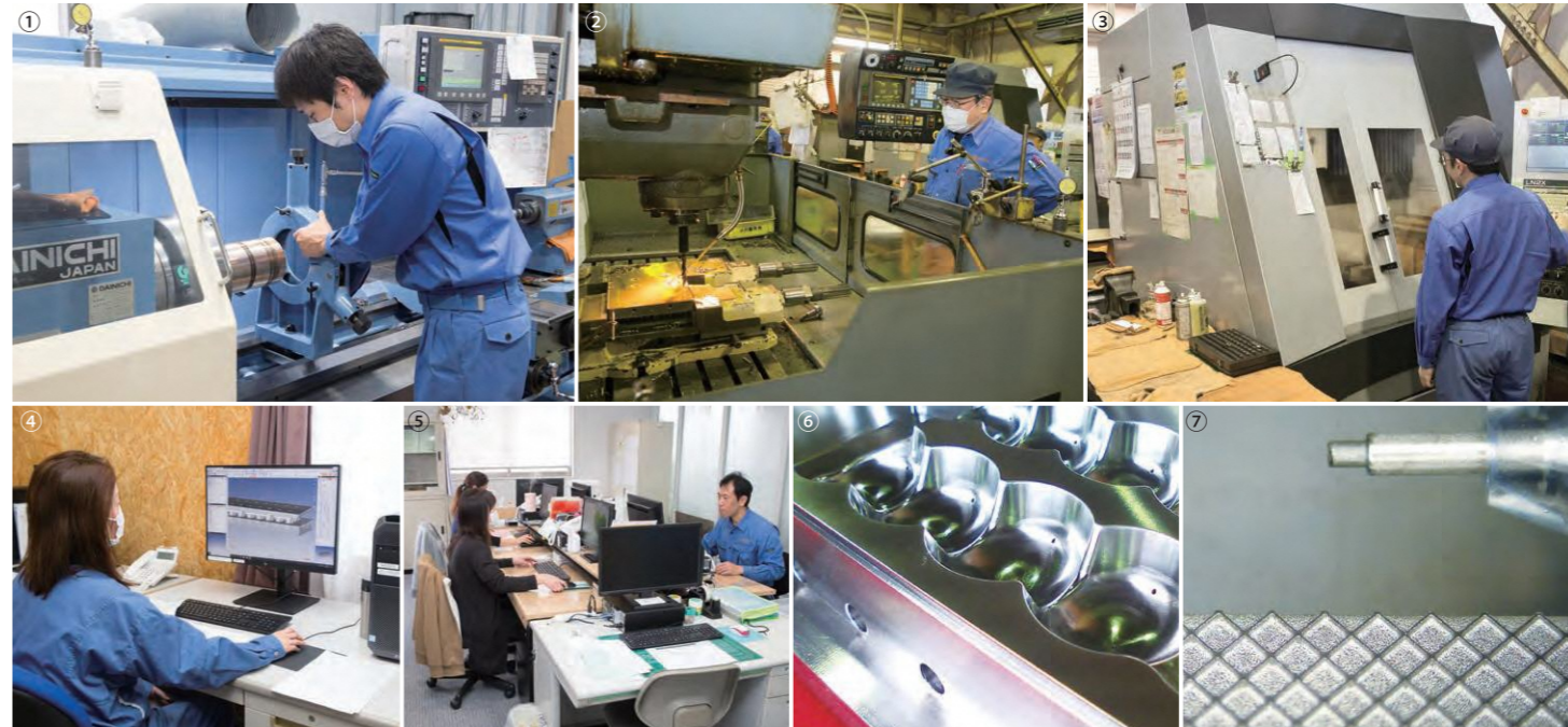
①確かな技術を身につけた若手社員は頼もしい存在だ ②③重量のある大型部品から超精密部品まで次々と仕上がっていく ④3D-CADソフトで製品の形状を確認する ⑤新社屋の事務所もきれいで働きやすい環境に ⑥できあがった鏡のような光沢の金型 ⑦シャープペンの芯よりも細かな加工がされた医療分野の部品
