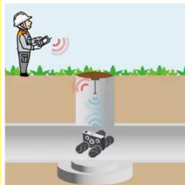
自走式ドローンによる下水道管路調査
