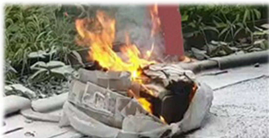
ごみ袋内の充電式電池（ポータブル電源）から出火した事例 ※ 東京消防庁HP引用
