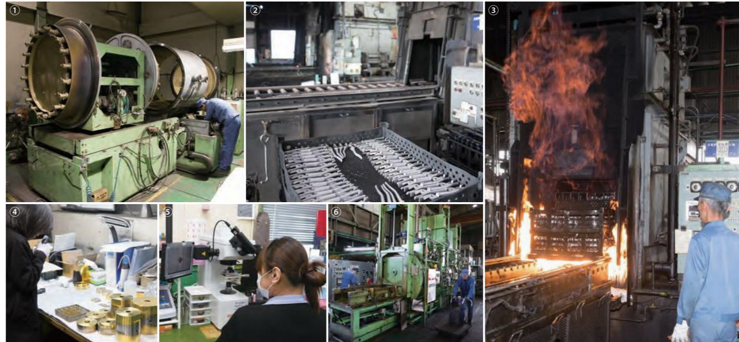
①イオンプレーティング装置 ②製品や部材の特性に合わせてセットして熱処理される ③熱処理された製品がガス浸炭炉から出る時、酸素の流入を防ぐために炎のカーテンに包まれる ④⑤炉内にサンプルを入れ、適正な処理が施されているか、人の目で確認する ⑥真空熱処理炉は、普遍的技術とされるまで発展・普及してきた
