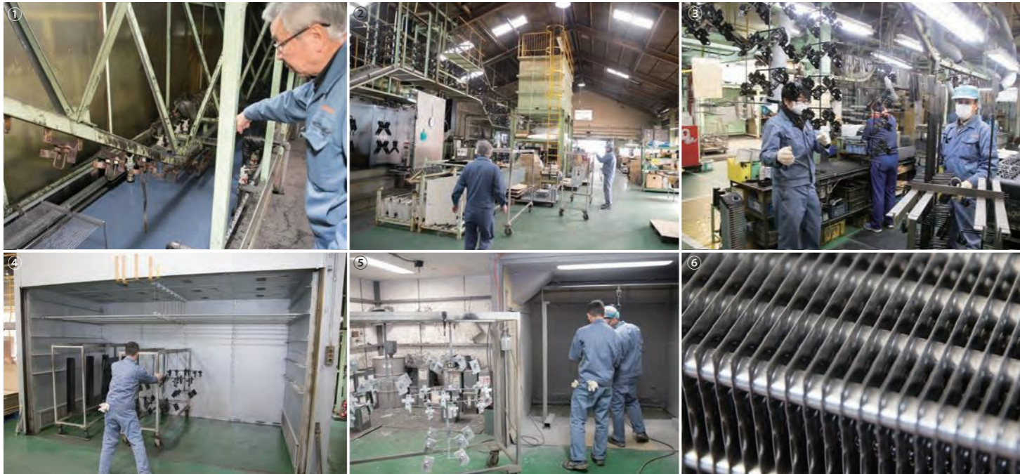
①吊り下げた製品を塗料に沈めて電着させる ②脱脂や水洗の前処理から電着塗装、水洗、乾燥を自動ラインで行う ③ラインセット、仕上がりは必ず人の手と目で確認 ④多くの製品を一度に乾燥させる大型パッチ炉 ⑤職人の技術で仕上げる化粧塗装 ⑥冷却用のフィンなど細かで複雑な製品にカチオン電着塗装は力を発揮する
