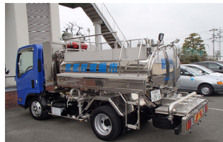
図 6-5 緊急対応給水車両
