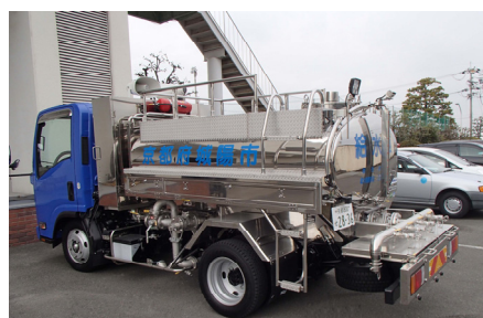
図 6-5 緊急対応給水車両
