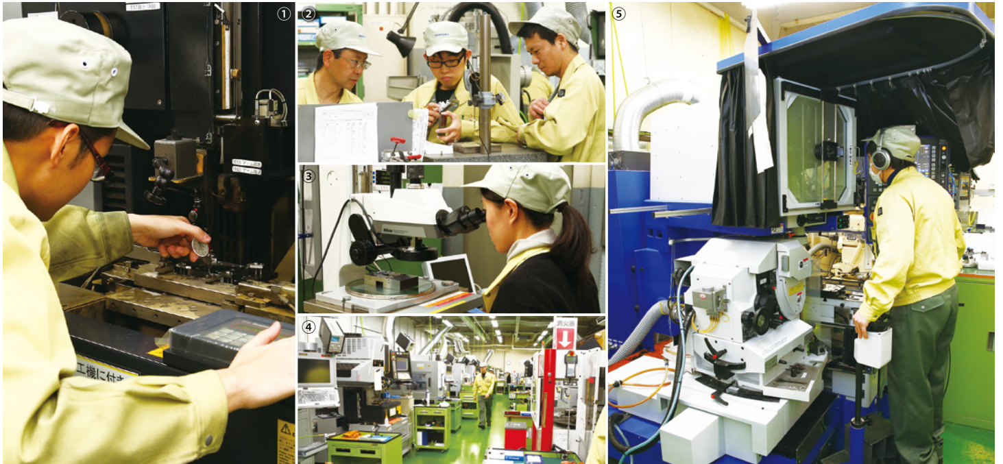
①気温や湿度などの環境で出る誤差を埋めるのが人間の経験と技 ②自然と輪ができて何でも相談できることがスキルアップに ③女性技師も多く活躍する ④精密な作業を行うため整理整頓された工場内 ⑤ヘッドホンは防音で装着しているのではなく、金型を削るときの音を聞き分けて、マイクロ単位で金型を加工しているようだ
