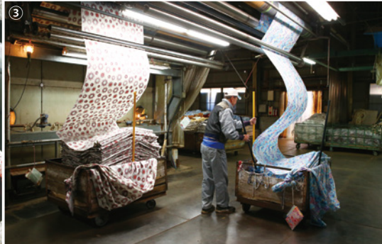
②オートスクリーン捺染機で版を調整する様子 ③スチーマーから出てくる綿布を見事な棒さばきでひとつひとつにまとめる
