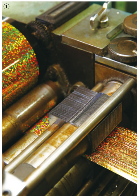
①着色したフィルムをマイクロスリッターでカットする ②撚糸を別の枠に巻きつけて糸を張ることで安定させる ③撚糸の作業中にゴミやホコリがないかチェックして、手作業で取り除く
