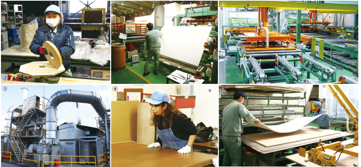
①エンドレスダップ積層シートの納品作業 ②④ダップ製品の検査は必ず人の触覚と目視で行う ③多くの化学製品を扱うため臭気やガスを検知し、無害化する装置が設置されている ⑤⑥含浸紙とボードをプレスするラインは自動化されているが、小ロットの要望に応えるために手作業のラインもある
