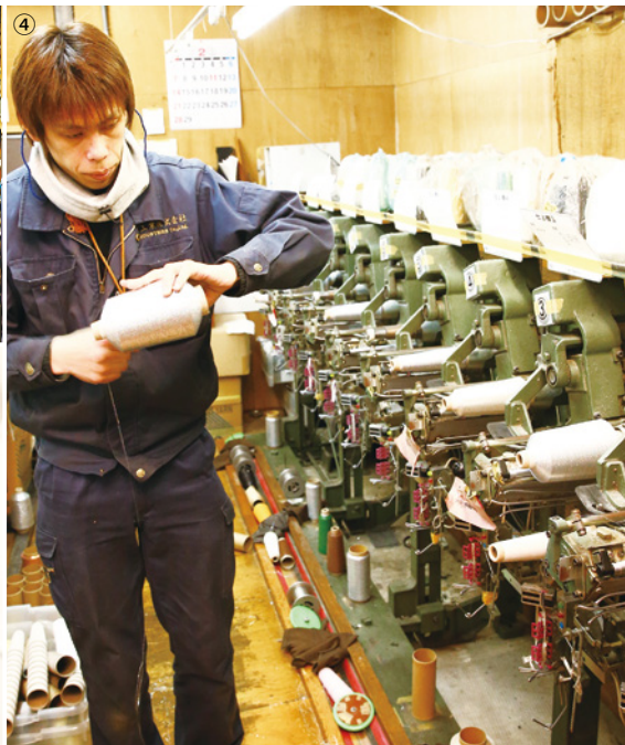
④マイクロスリッターでカットした糸を巻取機で巻き取るが、何十台の機械を数人で管理する
