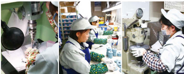
回転させて使用するため、砥石の中心に穴を空けている
