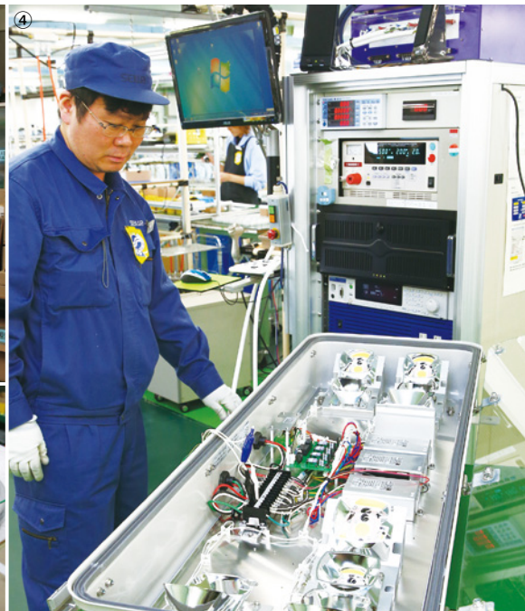
①トンネルの前に設置される情報表示システムの最終検査の様子 ②多品種少ロットに対応できる組み立て製造ラインはとても明るい ③産業用照明機器は明るく安全なLEDが主力になっている ④トンネル内に設置される照明装置の検査の様子
