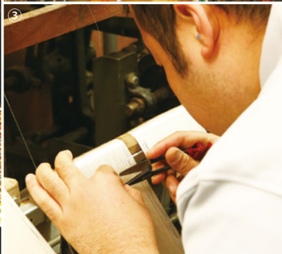
①着色したフィルムをマイクロスリッターでカットする ②撚糸を別の枠に巻きつけて糸を張ることで安定させる ③撚糸の作業中にゴミやホコリがないかチェックして、手作業で取り除く
