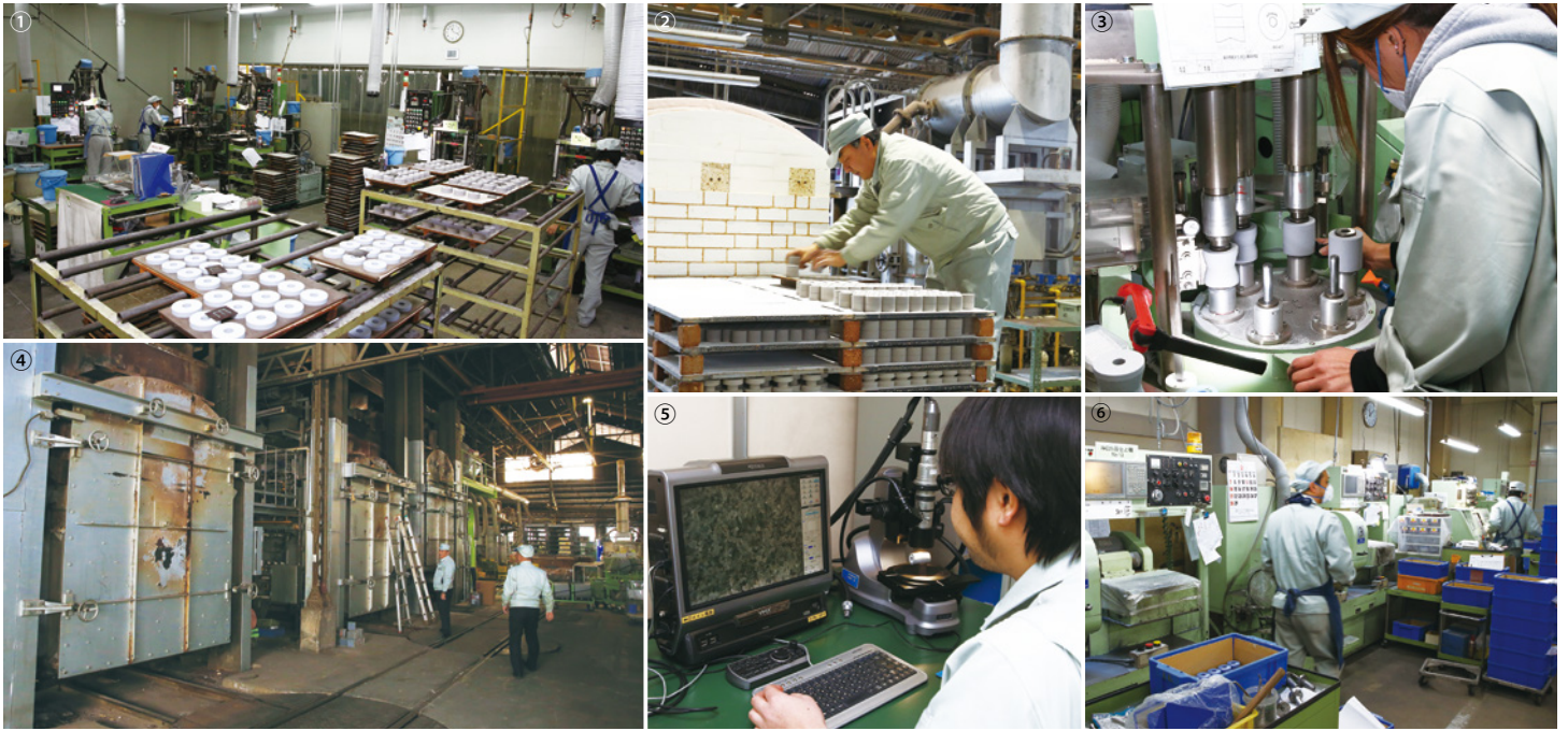
①工場内は機械ごとに空調ダクトが設置され、冷暖房が効いた環境が整っている ②ガス炉で入れる砥石を並べる様子は陶房のようだ ③④焼成した砥石を用途に合わせて成形する ④焼成するための巨大なガス炉 ⑤製品の状態をマイクロSCOPEで確認する
