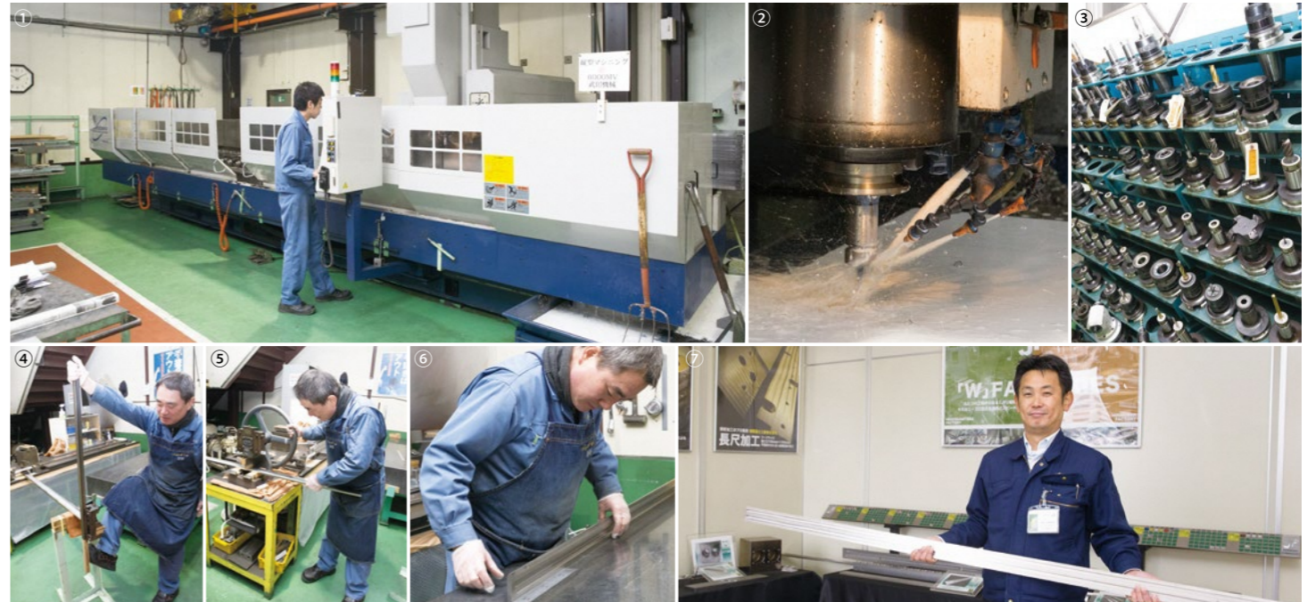
①②最長6mの製品を加工製造できる。③様々な加工に対応できるドリル。④⑤⑥長尺加工で難しいのが歪取りの作業。長年の経験を積んだ職人が、ひとつずつ微調整しながら製品を仕上げる。⑦長尺、超高精度に特化し、全国で知られるように様々な取り組みを行うことで新規開拓を成功させた社長の江森正和さん
