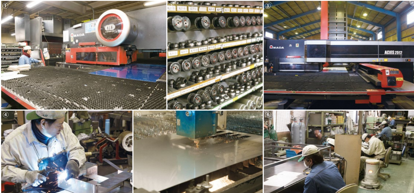
①無人運転で2倍の生産が可能なターレットパンチプレス ②数多く用意されたプレスの金型 ③第2工場に導入した最新ターレットパンチとレーザーの複合加工機 ④熟練職人の技術で高品質を実現 ⑤切断面が美しいクリーンカットができるレーザー加工機 ⑥組立や製品チェックは技術者の技と経験で行う
