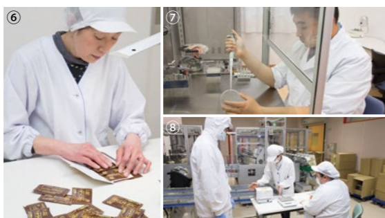
⑥試供品セットを心を込めて手作業で行う。⑦製造ロットごとに抜き取り検査で品質確認を行う。⑧自動で包装されたコーヒーは箱詰めも自動。最後に重さや外装を3人の検査員が確認している
