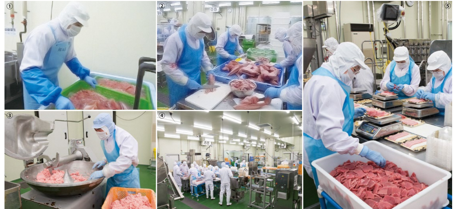
①冷凍マグロを解凍し、色や品質をチェック ②骨や筋、品質の満たない部位などを手作業で切り除いていく ③マグロをカッターで細かくし、味付けや食感を調整 ④衛生面に配慮し、協力して短時間で作業を行う ⑤マグロのたたきに切り落としをセットにした商品づくり。生鮮食品なので手際よく作業を行うのも重要
