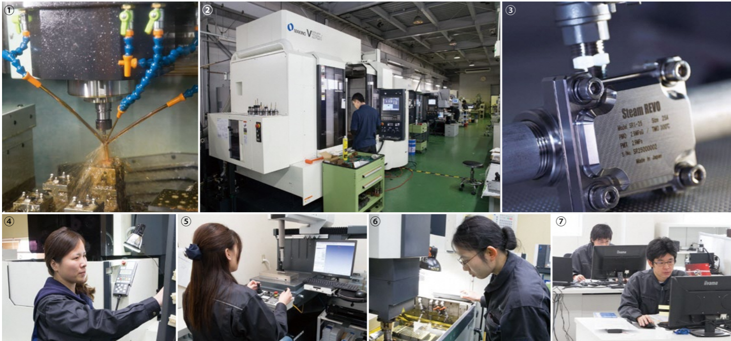
①②超精密金型も一般的なマシニングセンターでつくる。「なかなか信じてもらえませんが」と芦田社長。③自社製品第1号「Steam REVO」。蒸気からドレインだけを排出する自動弁で、流体力学に基づく可動部ゼロの革新的構造が、品質と寿命を飛躍的に高めた。④⑤⑥ShinSeiでは多くの女性エンジニアが活躍する。⑦様々な要望に応える開発部門
