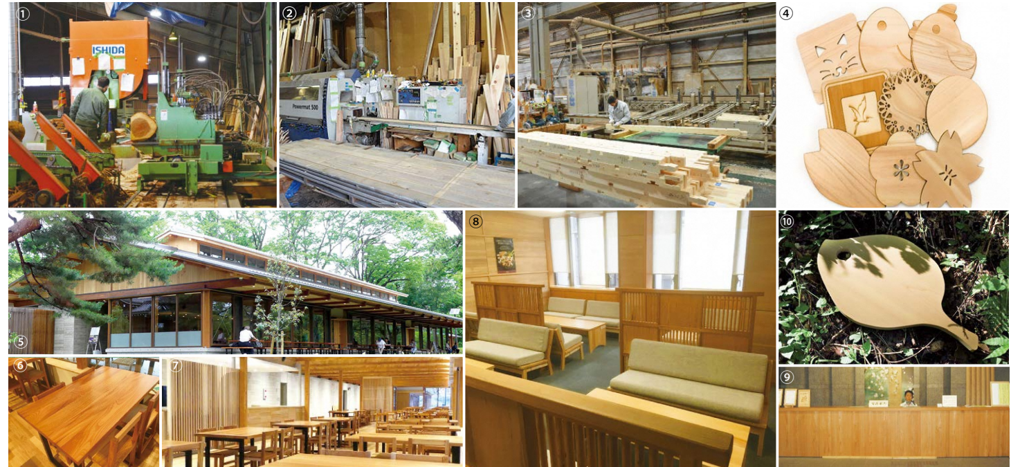
①原木の表皮を剥がして大きくカットする製材機 ②木材の表面を加工するモルダー機 ③住宅の建材の横架材加工 ④レーザー加工にて作成したコースター ⑤⑥京都御苑中立売休憩所 ⑦京都府庁知事待合室 ⑧京都府庁受付カウンター ⑨昨年度からふるさと納税の返礼品に出品中のまな板
