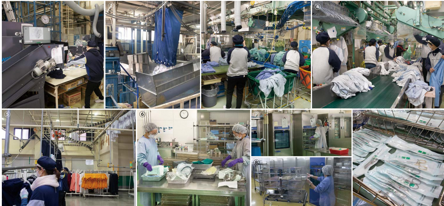
①ポケット内のチェックをX線で自動で検査 ②連続式洗濯機で大量の白衣やナース服を自動洗濯 ③服によってプレス・たたみを手作業で行う ④トンネルフィニッシャー前に手作業でハンガーにかける ⑤仕上がった服は自動で運搬 ⑥⑦⑧手術や治療で使った用具などを回収して、京都滅菌センターで消毒滅菌し、安心安全な治療を支えている
