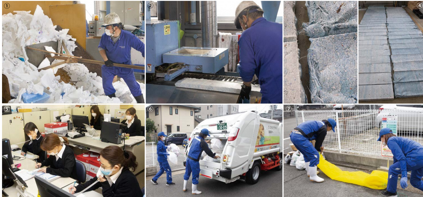
①発泡スチロールをプラントに入れる仕事を障がいのある社員が担当 ②③④不純物を除去・選別した発泡スチロールを粉砕・減容固化して高品質ポリスチレン原料が完成。建材などで再利用される ⑤子育てや家事と両立して勤務する女性も多いとか ⑥⑦市内の家庭ごみの回収・運搬の一部をナプラスが担当し、高く評価されている
