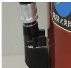
× 消火薬剤の漏れ
