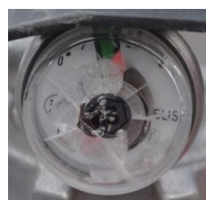
× 指示圧力計の損傷
