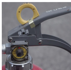
× 表示装置の脱落
