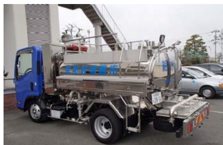
図 6-5 緊急対応給水車両
