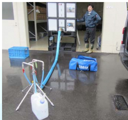
図 6-7 応急給水タンク
