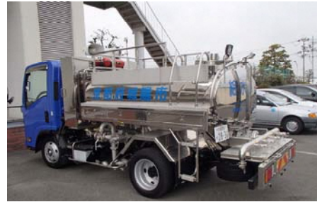
図 6-7 緊急対応給水車両
