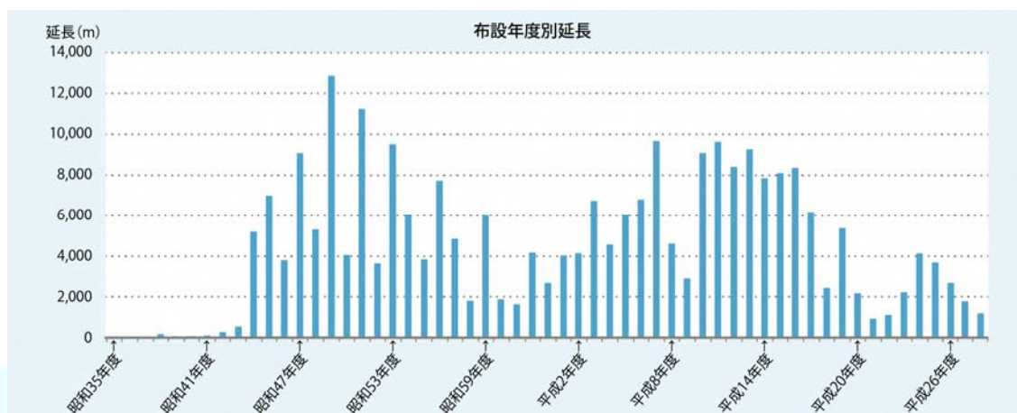
図 4-4 \phi 75\text{mm} 以上の管路の取得年度別延長
